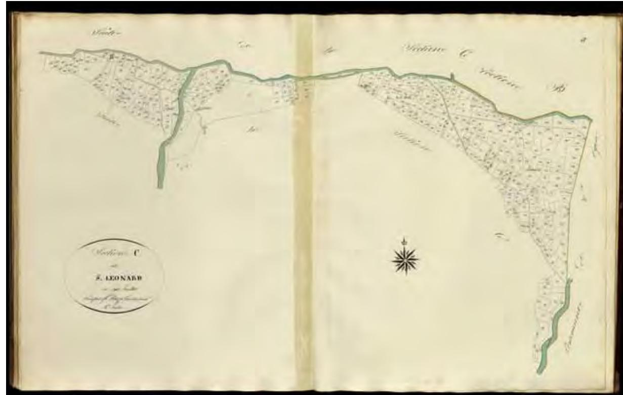
*Figura 69 Lettura delle sezioni del catasto napoleonico con l'utilizzo della matrice catastrale; in particolare si osserva che le tre particelle colorate in rosso sono dei mulini di conseguenza si intuisce che anche il ramo del corso d'acqua, benché non colorato in azzurro, è di fatto una derivazione del Torrente Artanavaz che serve i mulini*
